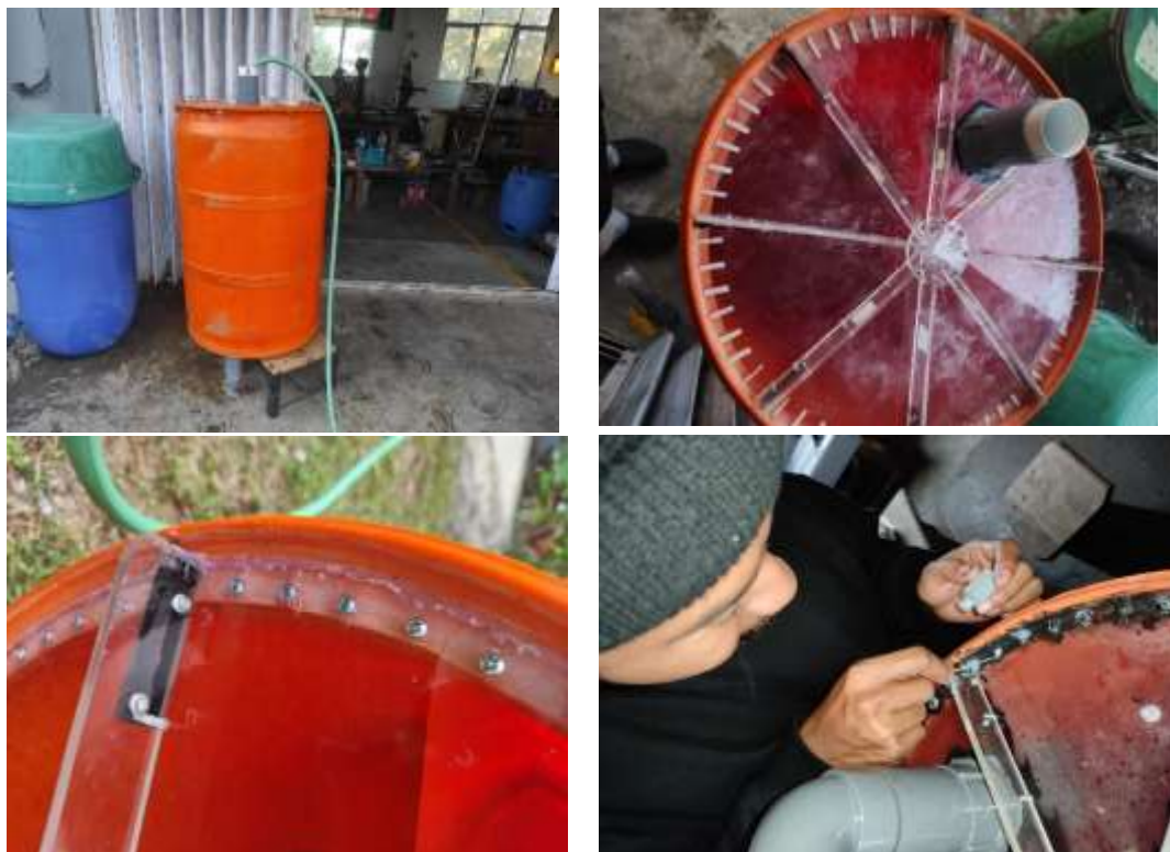
Gambar 4. Pengamatan kebocoran alat
