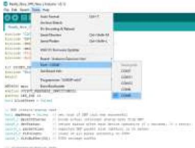
Gambar 10. Pengaturan Penggunaan Port pada Arduino IDE
