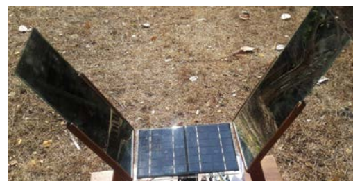
Gambar 6. Rangkaian keseluruhan Sistem Solar Reflector Panel Surya
