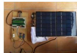
**Gambar 10.** Rangkaian Sistem Monitoring dan Pencatatan Data yang Dipasang pada Panel Surya
