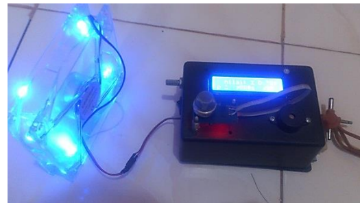
Gambar 6 Detektor LPG menggunakan sensor MQ-2 berbasis mikrokontroler ATmega 328
