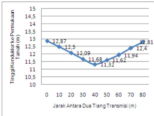
Gambar 16. Nilai Rata-rata Hasil Pengukuran Tinggi Konduktor ke Permukaan Tanah dan Nilai Kesalahan Relatif.
