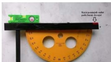
Gambar 5. Meletakkan *waterpass* di atas *clinometer* sederhana
