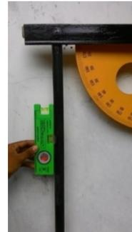
Gambar 6. Meletakkan *waterpass* di atas *clinometer* sederhana
