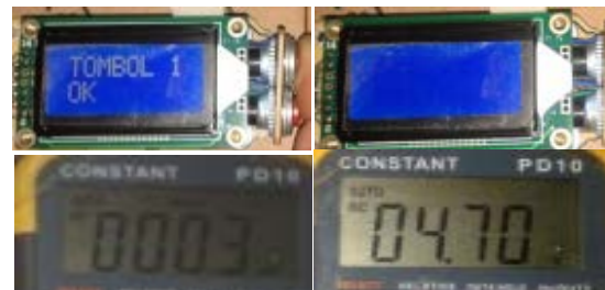
Gambar 8 Pengujian push button [a] ketika push button ditekan [b] ketika push button tidak ditekan
