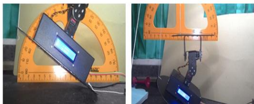
Gambar 8 Pengujian Penstabil Posisi Pada Sumbu X
