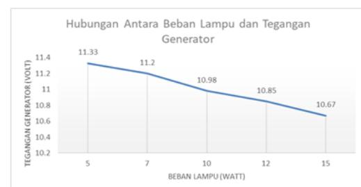
**Gambar 11.** Grafik Hubungan Antara Beban Lampu Terhadap Tegangan Generator
