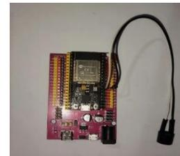
Gambar 8. Perakitan Buzzer Dengan ESP
