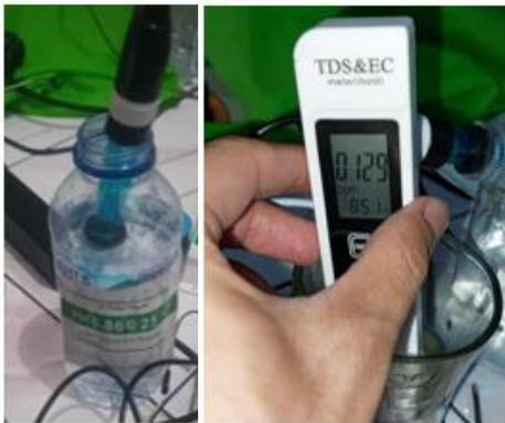
Gambar 8. Pengujian Akurasi Modul Sensor pH (a) dan TDS (b)
