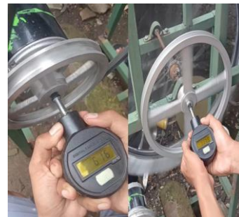
Gambar 9 Realisasi Pengukuran Putaran Turbin dan Generator.
