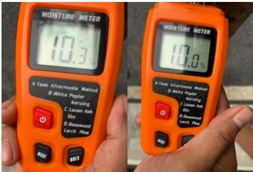
**Gambar 5** Proses Pengukuran Kadar Air Sampah Organik
