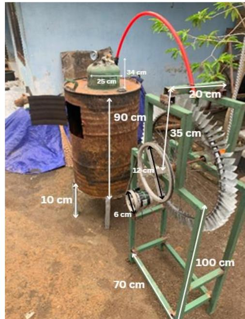
Gambar 3 Realisasi Ruang Pembakaran dan Boiler pada Prototype PLTSa
