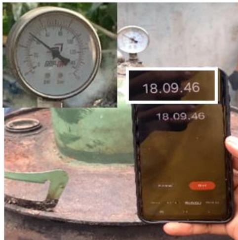
**Gambar 6** Pengukuran tekanan uap pada boiler dengan variasi komposisi sampah berbeda 7 kg organik + 3 kg anorganik.
