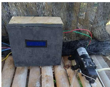
Gambar 5. Perangkat Sistem Pengatur Suhu Kelembaban Kumbung Jamur
