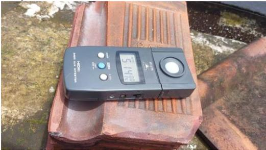
Gambar 7. Pengukuran PSH
