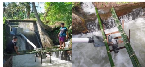
Gambar 6. Prototype PLTMH pada Anak Sungai Tukad Sunngi
