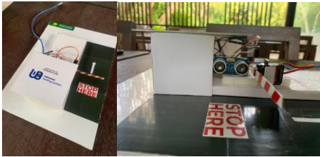
Gambar 23. Hasil Perancangan Prototype Palang Pintu Otomatis
