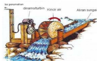
Gambar 2 Skema PLTMH Kincir Air
