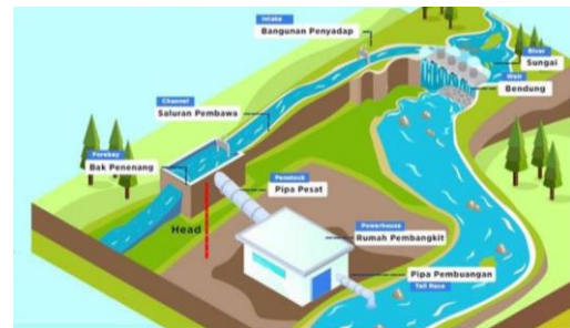
Gambar 1 Skema Umum PLTMH (Sumber: Widharma, 2021)
