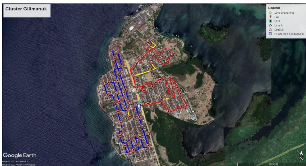
Gambar 5. Penempatan 32 FAT cascading 1:8 to 1:8
