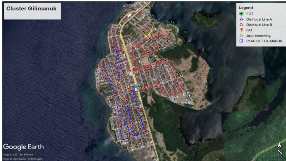
Gambar 4. Penempatan 32 FAT cascading 1:4 to 1:16
