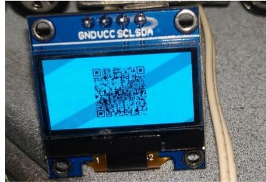
Gambar 14. Menampilkan QR CODE menggunakan LCD Oled
