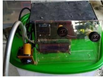
Gambar 12. Posisi sensor Proximity dan MXL90614 dan OLED Realisasi Hasil Rancangan Electronik alat kehadiran otomatis menggunakan QR CODE dilengkapi dengan pengukuran suhu dan cuci tangan.
