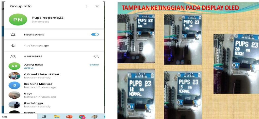
**Gambar 6.** Tampilan nama anggota grup telegram dan display ketinggian air pada OLED
