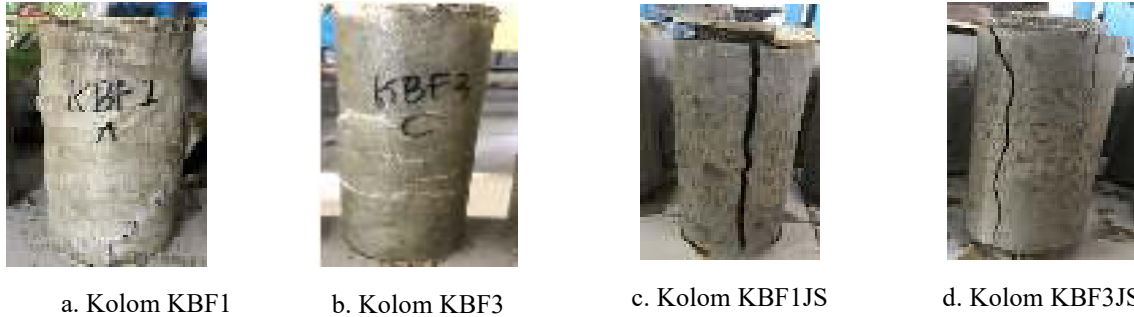
GAMBAR 2. MEKANISME KERUNTUHAN KOLOM KBF1, KBBF3, KBF1JS, KBF3JS
