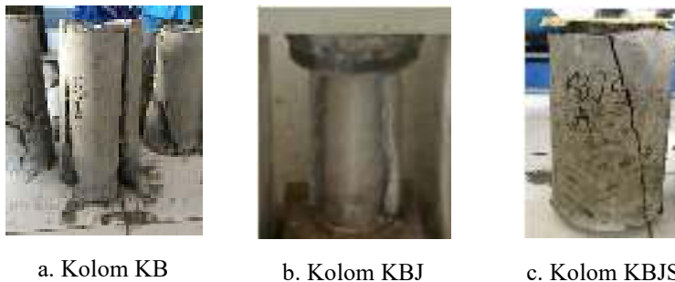
GAMBAR 1. MEKANISME KERUNTUHAN KOLOM KB, KBJ, KBJS
