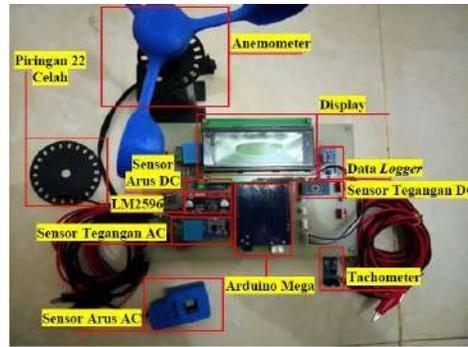
GAMBAR 3.2. ALAT UKUR DAYA GENERATOR
