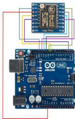
GAMBAR 2. RANGKAIAN TX LORa RA-02 PADA ARDUINO UNO
