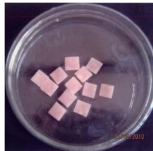
GAMBAR 1. PLAT AKRILIK UKURAN 10X10X1 MM
