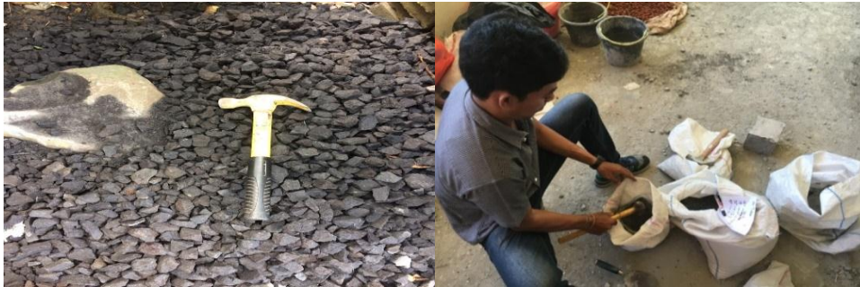
Gambar 1 Pembentukan Agregat Halus dari Limbah Batu Tabas
