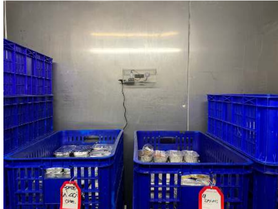
GAMBAR 7. PROTOTYPE YANG DILETAKKAN PADA DINDING COLD STORAGE
