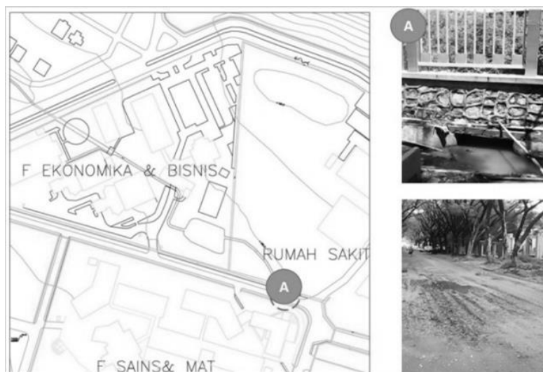
Gambar 7. Kondisi drainase pada beberapa titik kurang memadai sehingga pada kawasan ini pernah terjadi genangan dan banjir yang titik banjirnya ada di kawasan sekitar Fakultas Ekonomika Bisnis. Sumber: Dokumentasi survey lapangan
