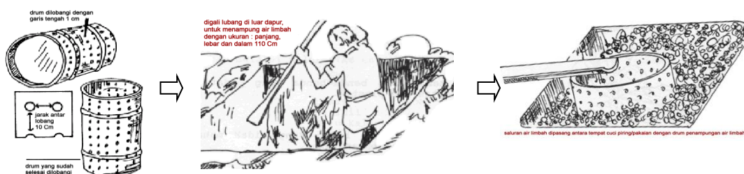
Gambar 8. Ilustrasi Saluran Septictank ke Sumur Peresapan
