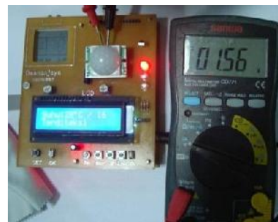
Gambar 9 PIR Mendeteksi Ada Gerakan
