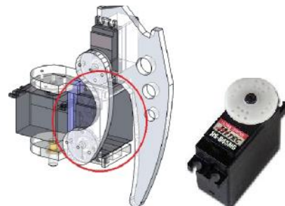
Gambar 4 Posisi penempatan servo HS-645MG dan bentuk fisik servo HS-645MG
