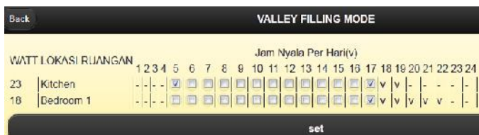
Gambar 11. Screenshot tampilan editing page untuk pola pembebanan Valley Filling Mode (contoh pengisian ruang Kitchen dan Bedroom 1 , Gambar 6).
