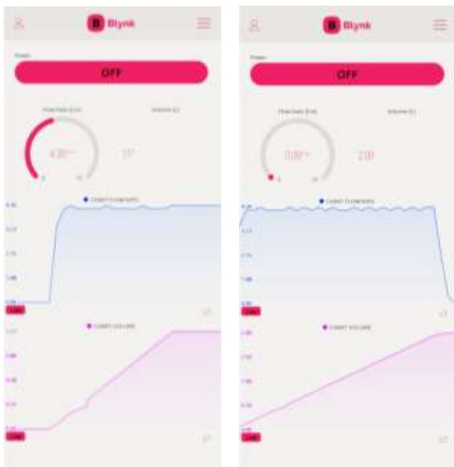
Gambar 4. Tampilan Aplikasi Android Perhitungan Debit dan Volume Air, 1 dan 2 Liter dengan Tegangan 8V.
