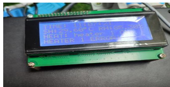
Gambar 14. Pengujian Notifikasi Kerusakan Heater
