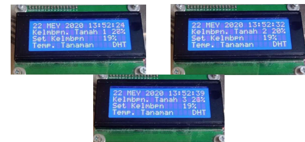
Gambar 3: Hasil Pengukuran Sensor I, II, dan III Pada Tanah Cukup Basah dengan Tingkat Kelembaban Tanah yang Terukur Pada Masing-masing Sensor Yaitu Sebesar 27%, 21%, dan 28%
