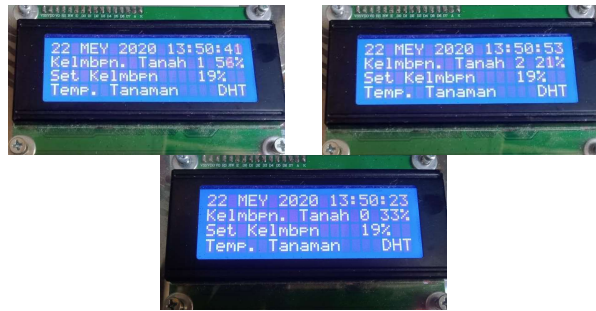
Gambar 4: Hasil Pengukuran Sensor I, II, dan III Pada Tanah Basah dengan Tingkat Kelembaban Tanah yang Terukur Pada Masing-masing Sensor Yaitu Sebesar 53%, 33%, dan 28%
