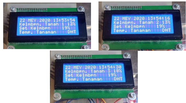
Gambar 2: Hasil Pengukuran Sensor I, II, dan III Pada Tanah Kering dengan Tingkat Kelembaban Tanah yang Terukur Pada Masing-masing Sensor Yaitu Sebesar 13%, 13%, dan 18%
