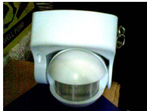
Gambar 6. Kotak dinding sensor gerak
