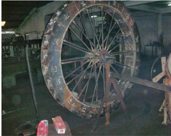
**Gambar 8. Turbin sudah berbentuk dengan diameter 2 meter**
