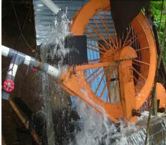
Gambar 12. Pipa pesat yang melewati air sudah memutar kincir
