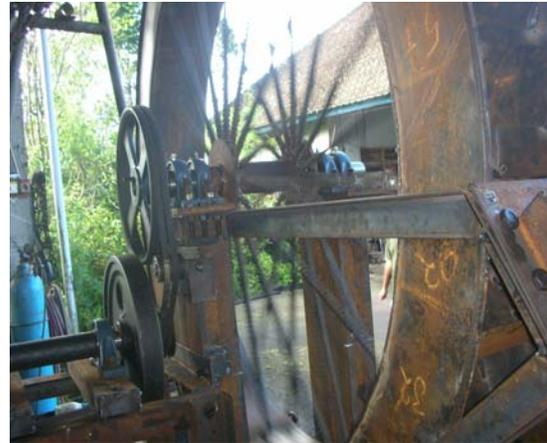
**Gambar 9. Pembuatan konsktruksi Roda gila di Bengkel Sinar Mas Pempatan**
