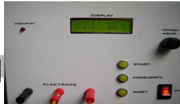
Gambar 6. Indikator LED Menyala dan Jumlah Detak Jantung Bertambah pada Layar LCD
