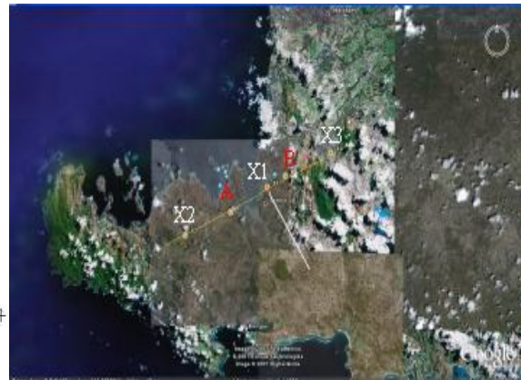
Gambar 3. Kondisi topografi rencana awal titik-titik VES (X 1 , X 2 and X 3 ). Titik A dan B masing-masing posisi anomali geomagnetik minimum dan maksimum
