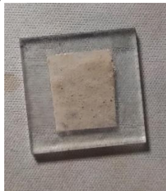
Gambar 8 Pelat kaca yang sudah dilapisi dengan nanorod ZnO.
