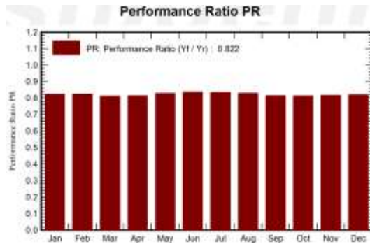
Gambar 7. (c) Hasil Simulasi Pembangkitan Energi Listrik PLTS 61,6 kWp
