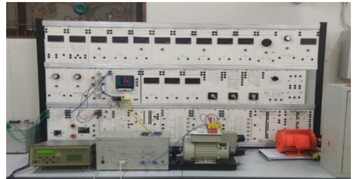
Gambar 2: Rangkaian pengujian motor induksi dengan beban bervariasi
