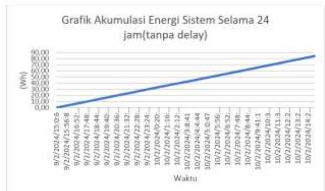
Gambar 13: Hasil Pengujian Mandiri Energi dengan Pengiriman Data Tanpa Delay yang Dikonsumsi Sistem
