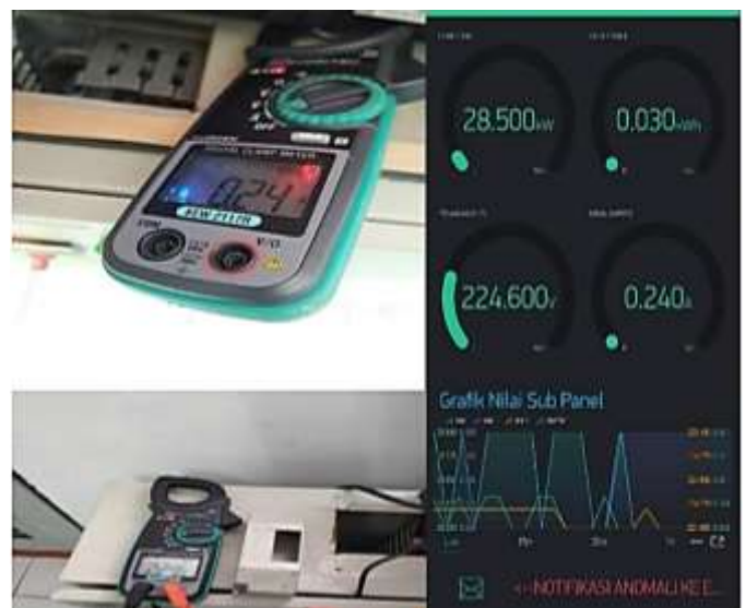
Gambar 6: Kalibrasi Sistem IoT dengan Tang Amper KEW 2117R
