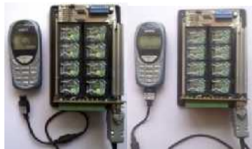
A. HP statis belum terpasang relay semua on/kiri B. HP statis sudah terpasang relay semua off/kanan
