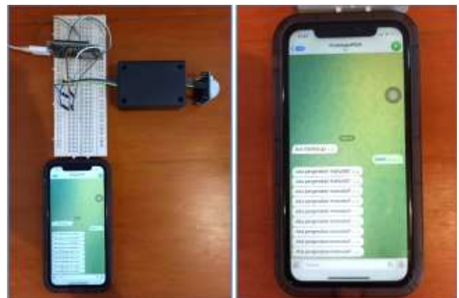
Gambar 12: Pelaksanaan pengujian subsistem komunikasi internet of things
