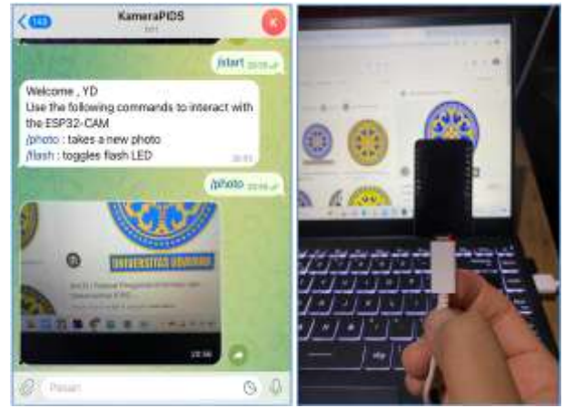
Gambar 14: Pelaksanaan pengujian subsistem pengambilan gambar
