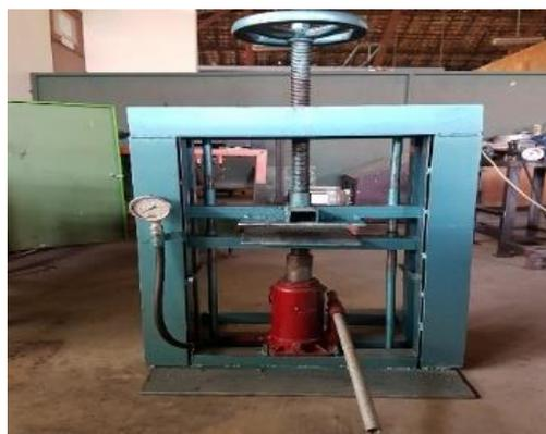
Gambar 5 Alat Press kapasitas 10 ton
