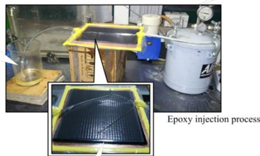
Gambar 1. Proses fabrikasi laminasi komposit dengan VARTM
