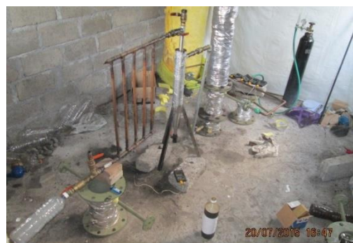
Gambar 3. Sistem Gasifikasi saat Penelitian
