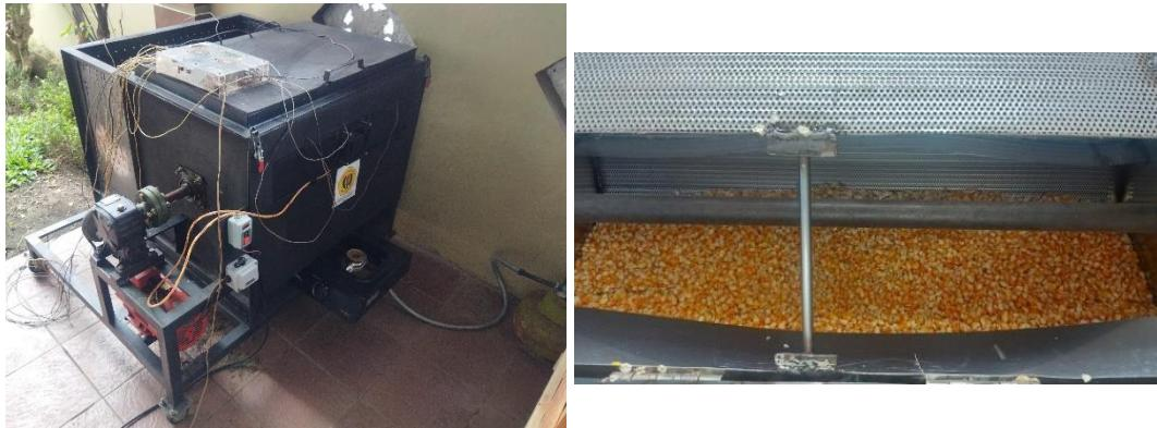
Gambar 2. Pengujian sampel 20 kg biji jagung
