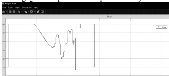
Gambar 20. Hasil Error Ketinggian Terbang Drone Tanpa Fuzzy
