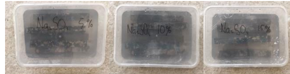
Gambar 3. Perendaman Dengan Natrium Sulfat
